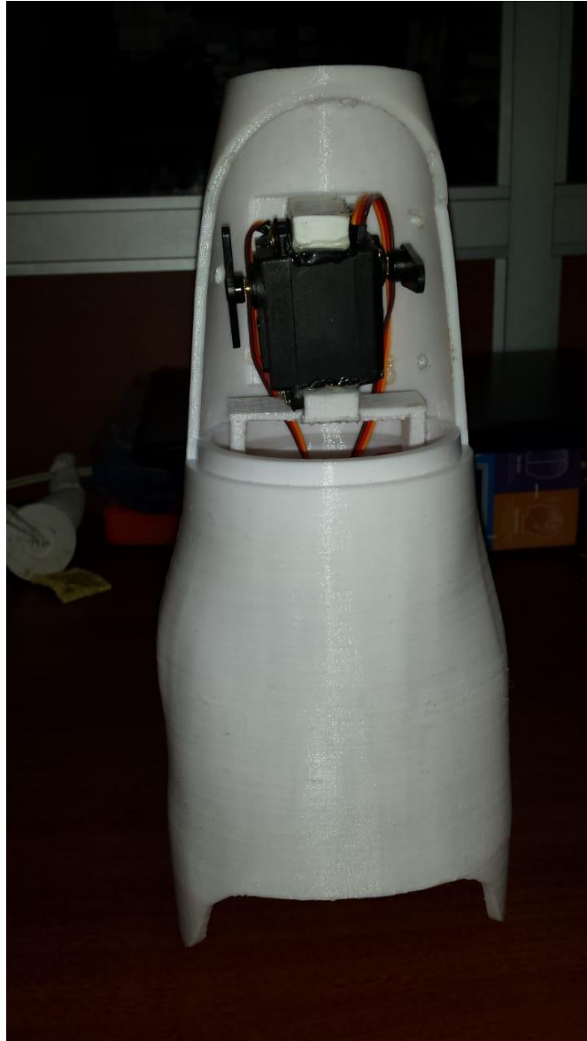
Figura 3.39. Dos servos sujetos y fijos en el espaciamiento interno de la prótesis.
