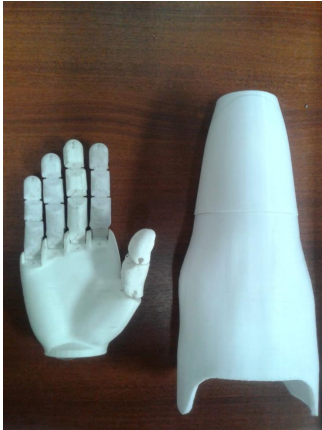
Figura 3.32. Mano derecha y antebrazo completo impresos en 3D.
