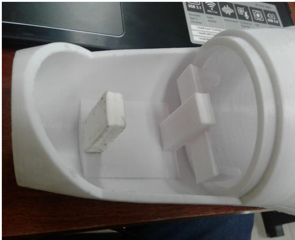
Figura 3.36. Espaciado interno en la prótesis para los servomotores.
