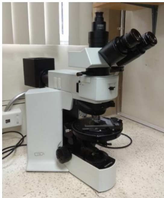
Figura 3.6. Microscopio de luz transmitida/reflejada empleado para el análisis de secciones pulidas.
