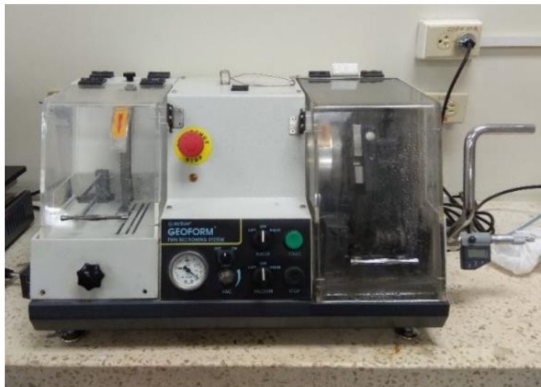
Figura 3.2. Equipo Geoform usado en el corte y desbaste de las secciones delgadas.
