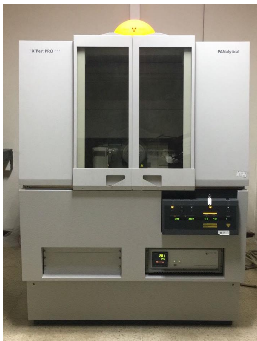
Figura 3.7. Equipo PANalytical X'Pert Pro usado para la Difractometría de Rayos X.
