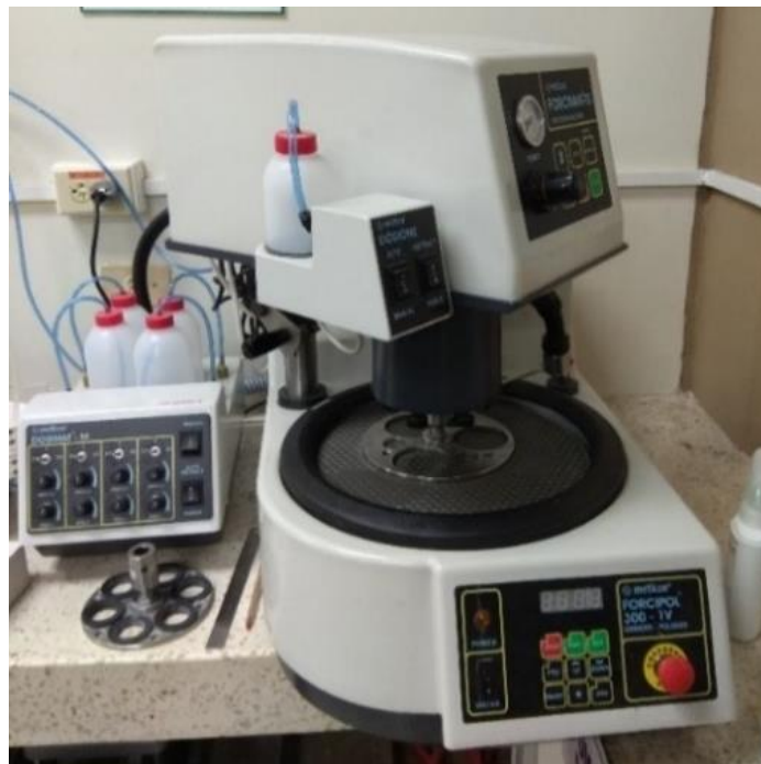
Figura 3.5. Equipo Forcimat empleado en el pulido final de las secciones pulidas.
