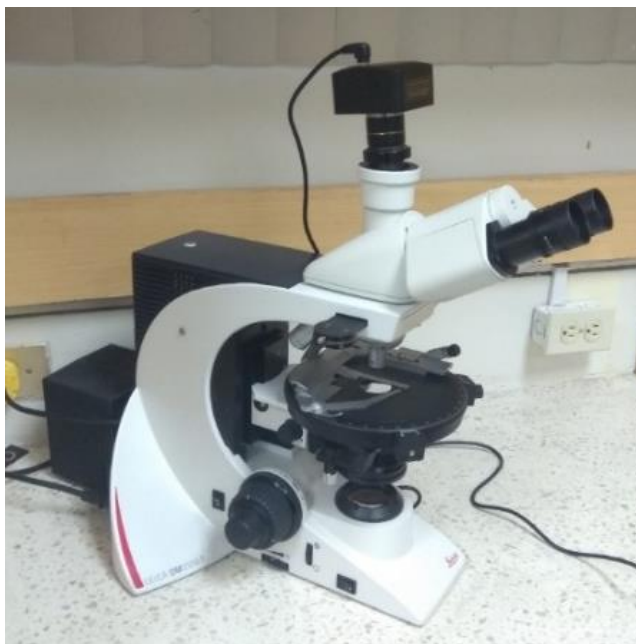
Figura 3.3. Microscopio de luz polarizada empleado para el análisis de secciones delgadas.
