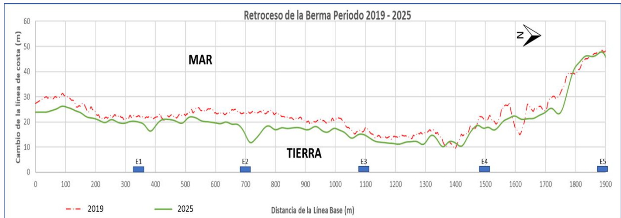
Figura 3.27 Retroceso de la berma 2019-2025, sin muro de protección (Autores, 2019)
