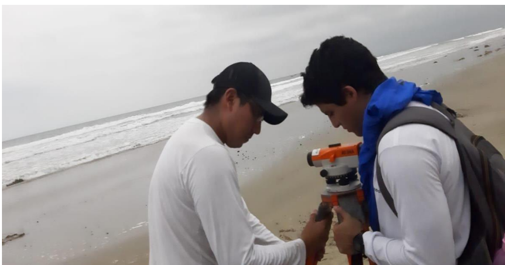
Levantamiento de perfil de playa con nivel y estadia
