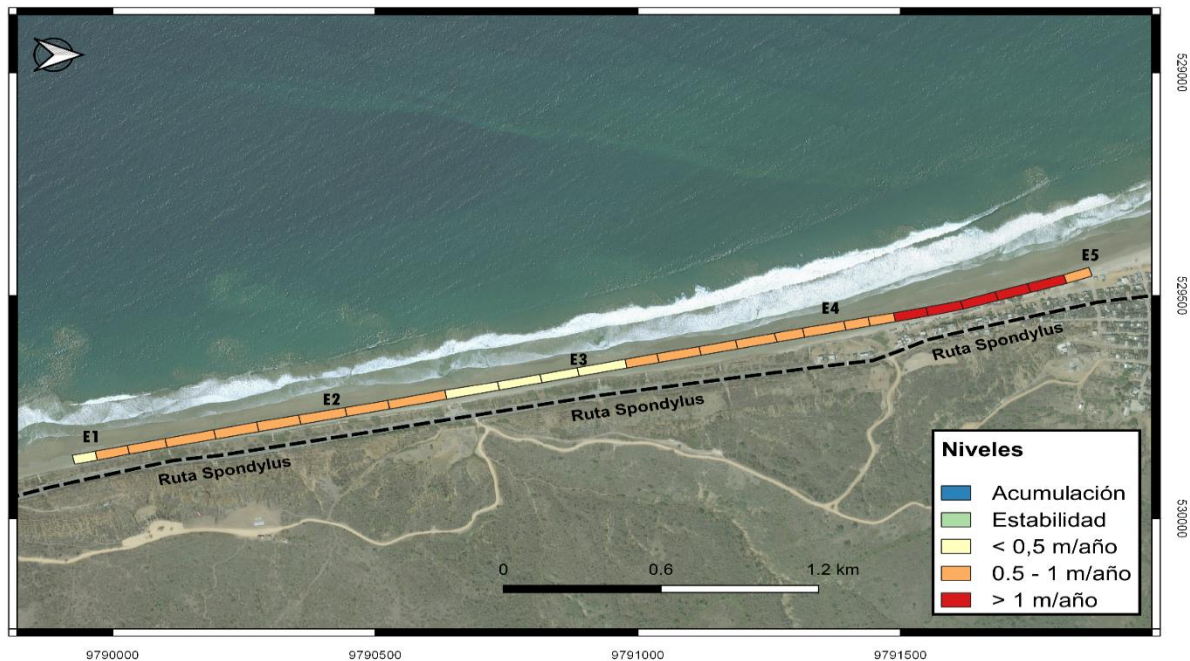
Figura 3.18 Zonificación del retroceso de la línea de costa período 2006-2013 (Autores, 2019)
