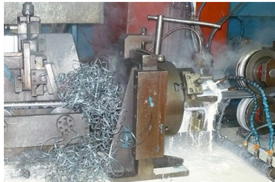
Figura 3.10 DESBARBADO DEL TUBO
