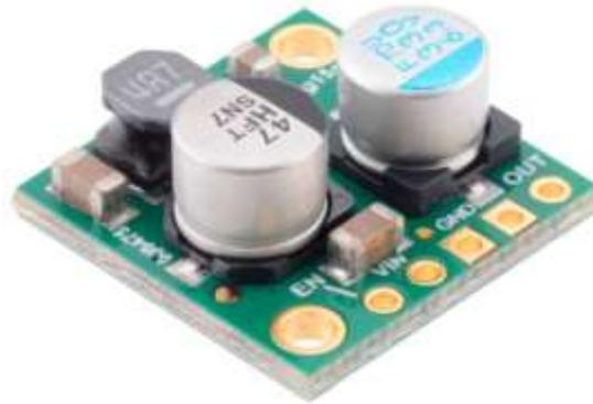
**Imagen 2.9 Convertidor de señal de alimentación de 14V a 5V
