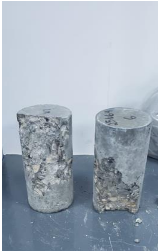
Ilustración 2.11: Cilindros después de fallar a la compresión
