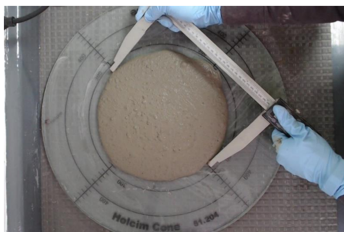
Ilustración 2.24: Medición del diámetro esparcido
