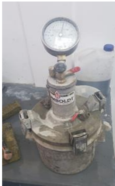
Ilustración 2.6: Olla de presión para contenido de aire
