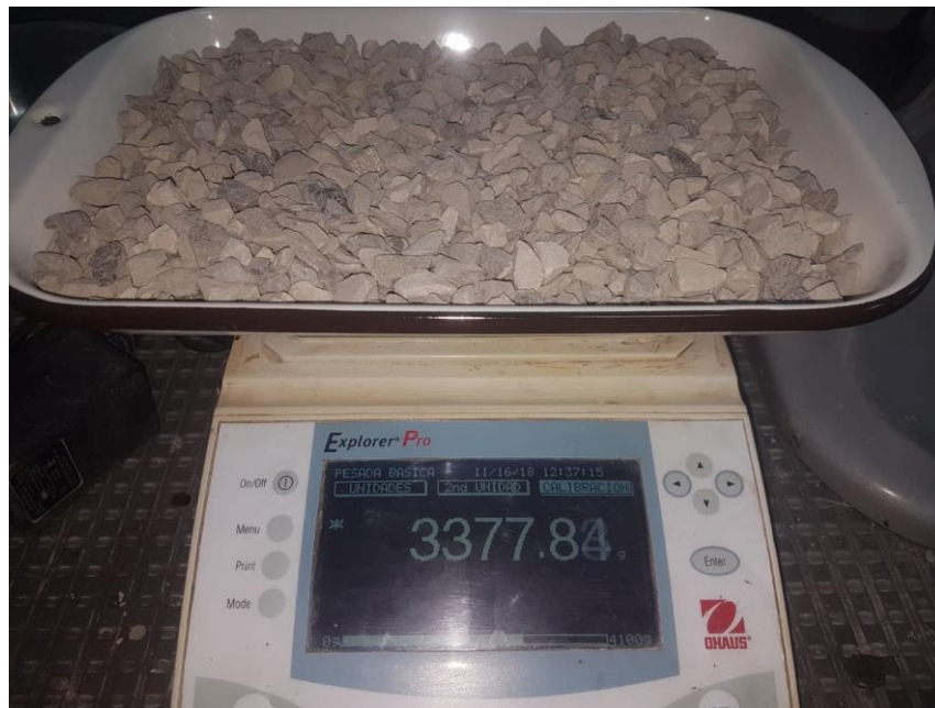
Ilustración 2.5: Peso de muestra de agregado grueso
