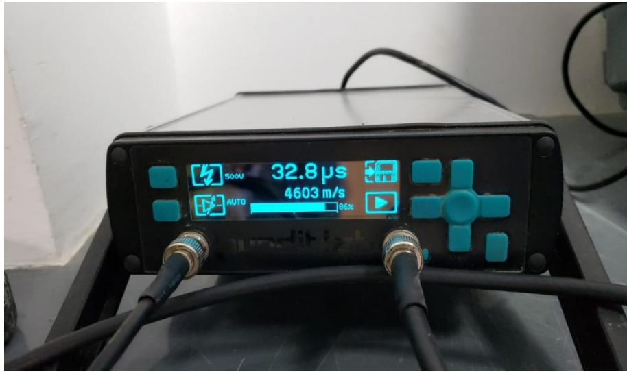
Ilustración 2.21: Datos obtenidos del equipo de Ultrasonido
