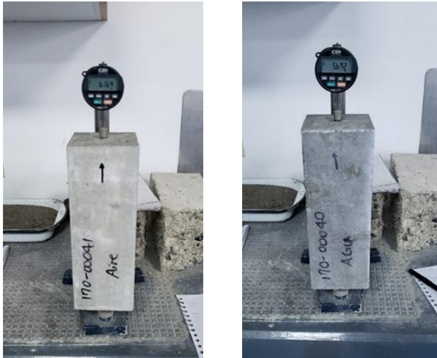
Ilustración 2.13: Lectura de viga expuesta al aire (izquierda) Lectura de viga curada en Agua (derecha)
