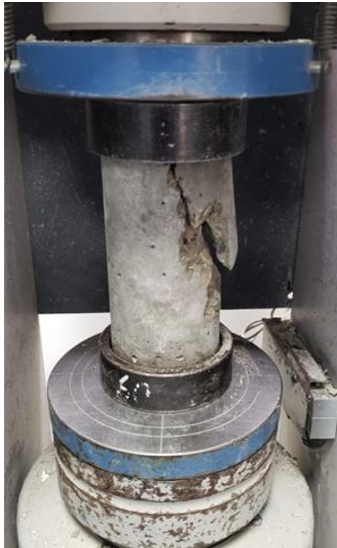
Ilustración 2.10: Rotura de cilindro a compresión
