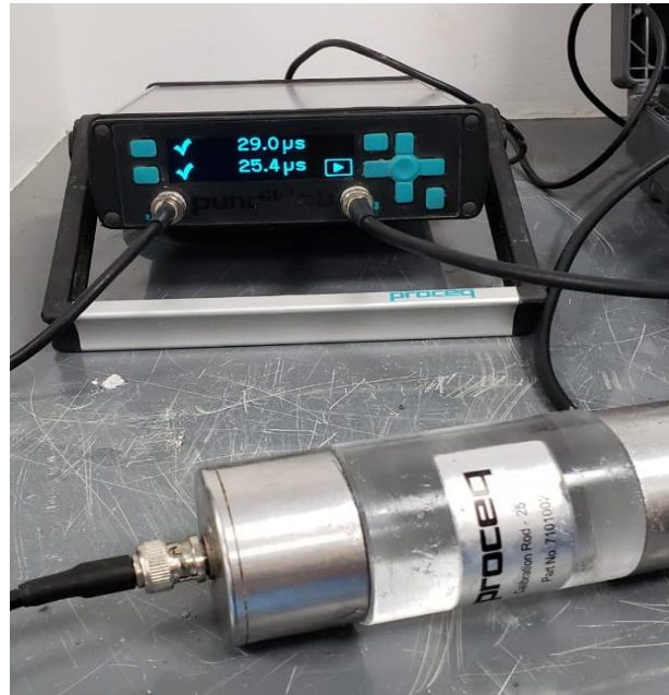
Ilustración 2.20: Calibración del equipo de Ultrasonido
