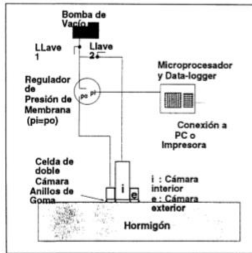
Ilustración 2.15: Descripción del ensayo de Torrent
