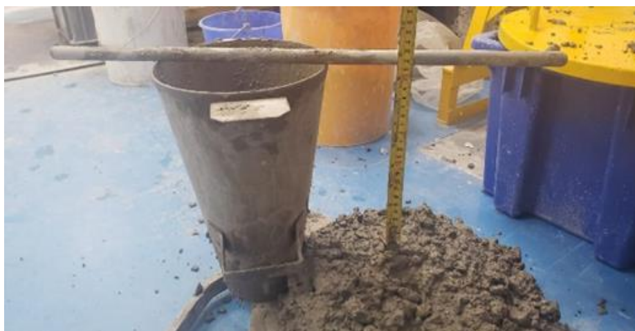
Ilustración 2.7: Lectura de asentamiento del hormigón
