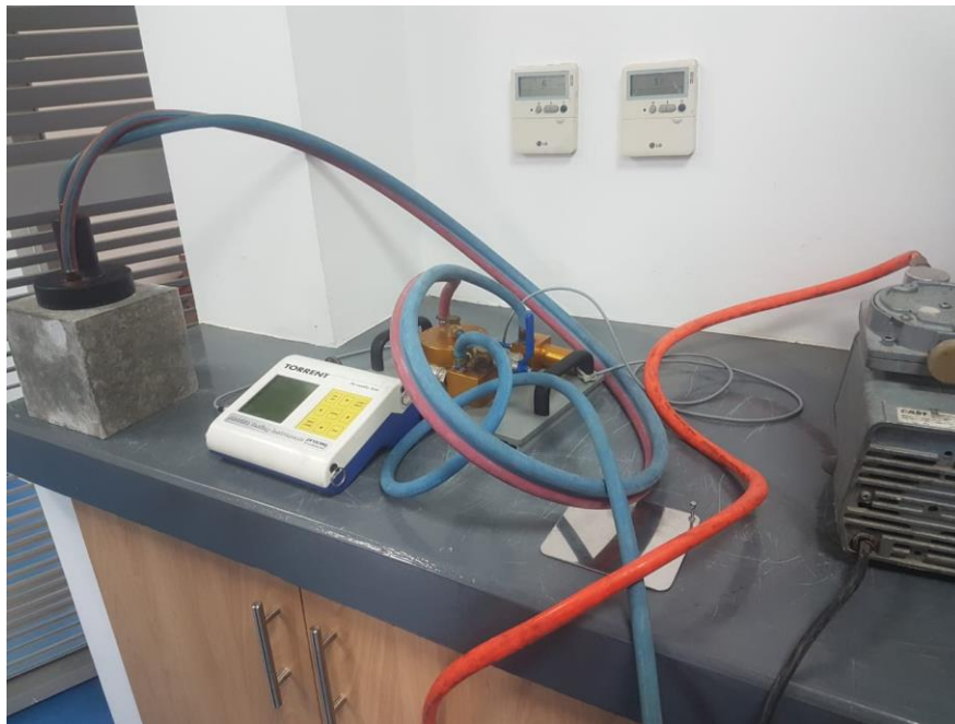
Ilustración 2.16: Instalación del equipo de Torrent
