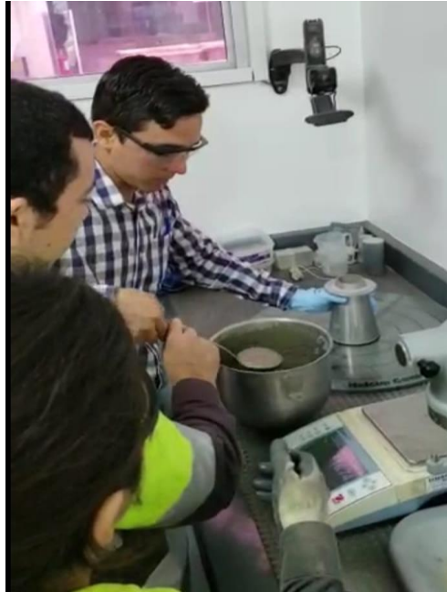
Ilustración 2.23: Fase de llenado del Holcim Cone
