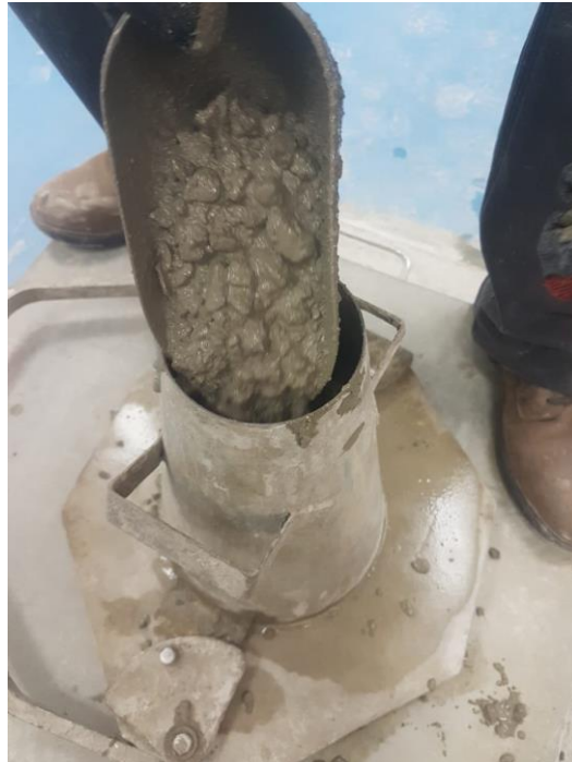
Ilustración 2.9: Llenado de capas del cono de Abrams
