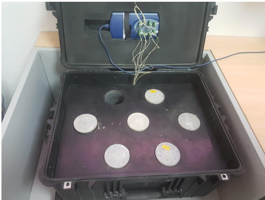
Ilustración 2.25: Equipo de medición de Holcim Heat
