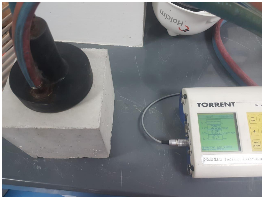
Ilustración 2.14: Instrumento de ensayo de Torrent
