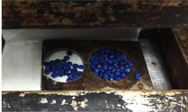
**Figura 2.5 Discos para el ensayo reológico**
