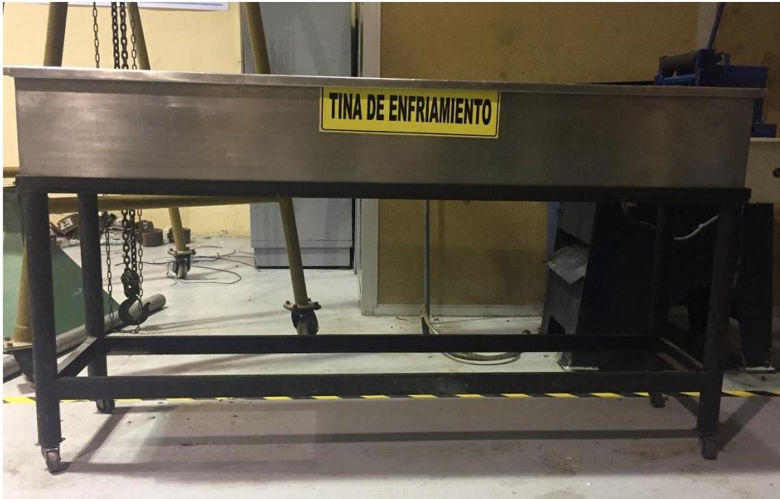
**Figura D1. Tina de enfriamiento del laboratorio**
