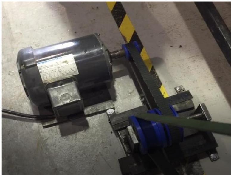
**Figura D2. Conjunto de poleas del motor**
