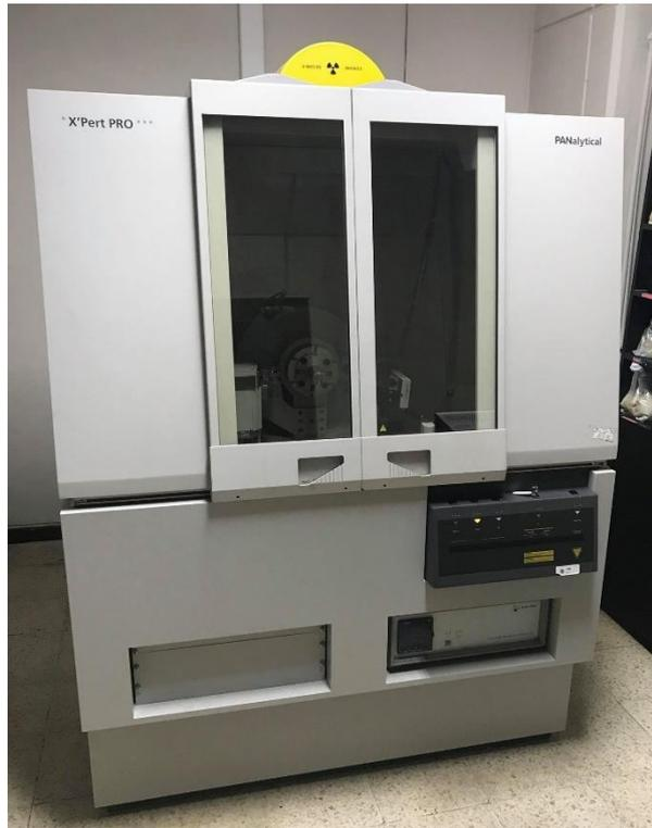
**Figura 2.7 Difractómetro de Rayos X**
