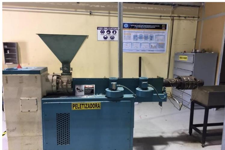
**Figura 2.8 Extrusora de tornillo simple**
