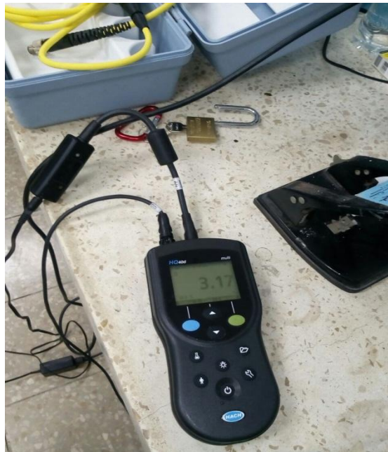
ILUSTRACIÓN 2. EQUIPO MULTIPARÁMETROS PARA MEDICIÓN DE ÓXIGENO, TEMPERATURA Y SALINIDAD
