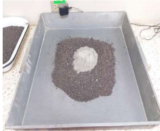
Terreno Natural previo a ser mezclado con cemento Holcim Agrovial
