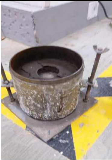
Cilindro luego de pasar por prensa de CBR
