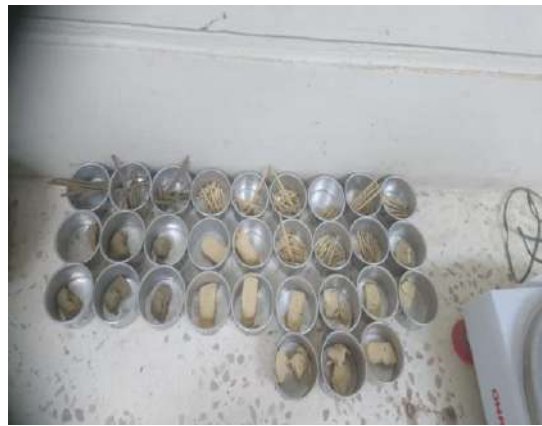
Ensayo Límites de Atterberg realizado a las diferentes muestras
