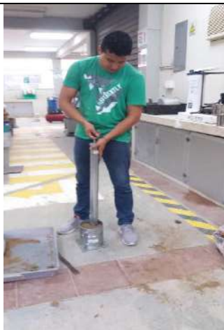
Compactación ensayo Próctor con martillo de 10lb
