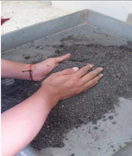
Resultado de mezcla suelo – cemento en muestra 3
