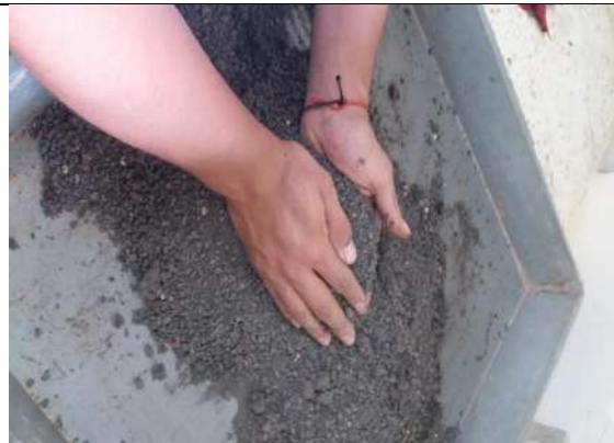
Homogenización de Terreno Natural para encontrar la con cantidad óptima de agua en muestra.
