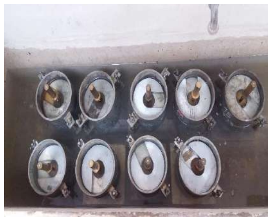
Colocado de cilindros en piscina para realización de ensayo CBR
