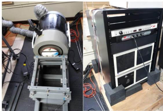
Figura 2. 5: Equipo generador de vibraciones
