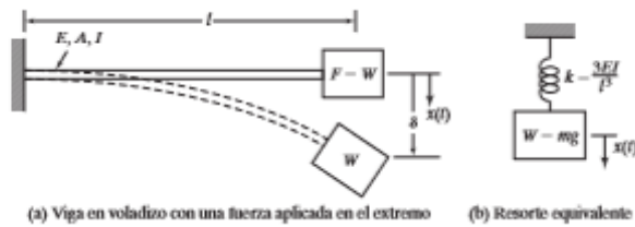
Figura 2. 14: Modelo utilizado para cálculo de la constante de resorte [(Rao S. , 2012)]
