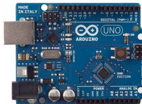
Figura 1. 8: Modelo de una tarjeta Arduino [ (Ojeda, s.f.)]
