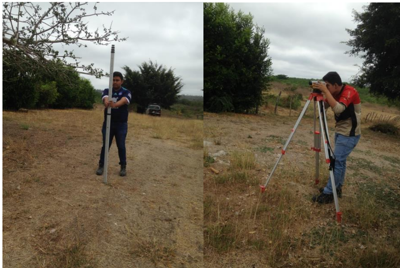
Figura 2.5- Levantamiento de la vía utilizando equipos topográficos
