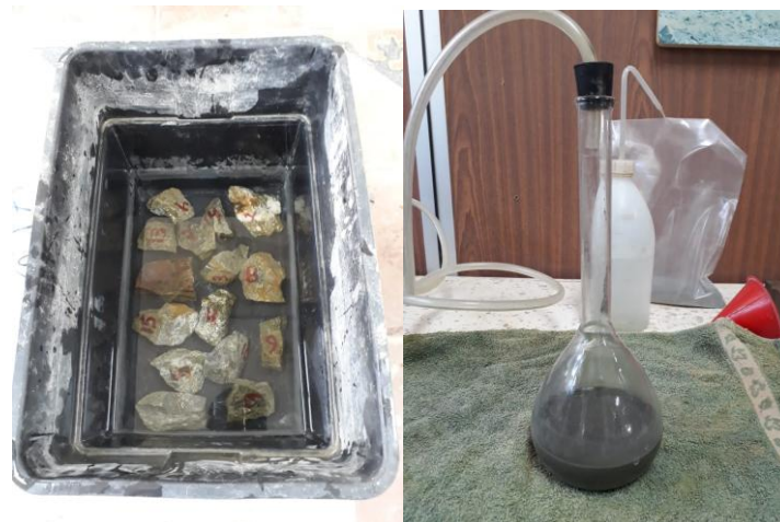
Figura 2.10. Proceso de determinación de densidad aparente y real.
