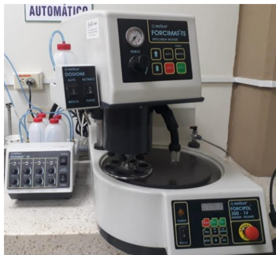
Figura 2.7 Equipo de pulido de secciones pulidas.
