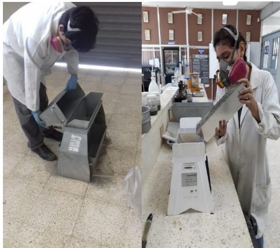
Figura 2.5. Proceso de homogenización y cuarteo.
