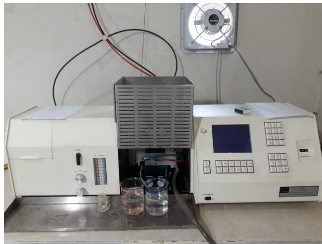
Figura 2.9. Espectrofotómetro de absorción atómica.
