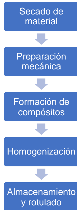
Figura 2.2. Proceso de preparación y formación de compósitos.
