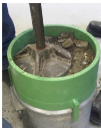
Figura 13 Compactación del HCR en la Olla de Washington
