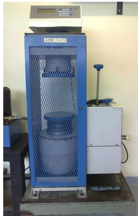
Figura 20 Prensa ELE ADR 2000kN
