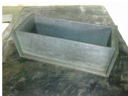
Figura 25 Vigueta metálica de dimensiones 102 x 102 x 286 mm
