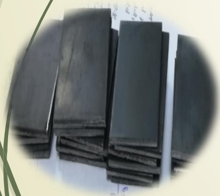
Gráfica 9: Láminas de acero al carbono A36
