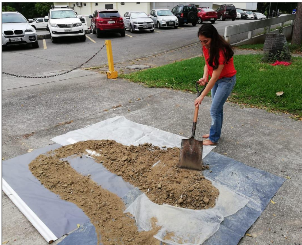
Figura 2. 15 Secado de las muestras en las instalaciones del Laboratorio de Suelos FICT.
