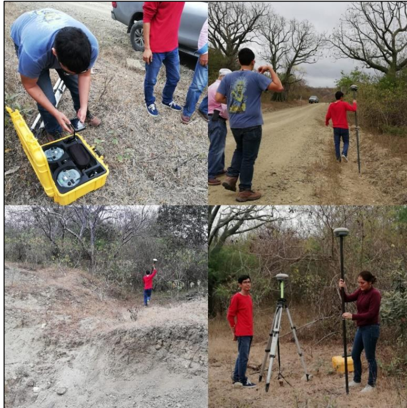
Figura 2. 7 Toma de datos topográficos mediante GPS diferencial en la cuenca # 3
