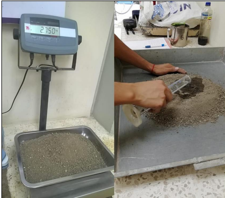
Figura 2. 17 Desarrollo del ensayo de Proctor en las instalaciones del laboratorio.
