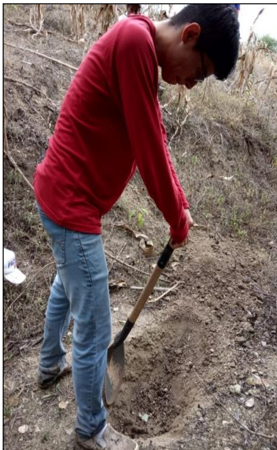
Figura 2. 13 Elaboración de calicatas en Cuenca # 1 “El Mate” (detalle del suelo: color claro).
