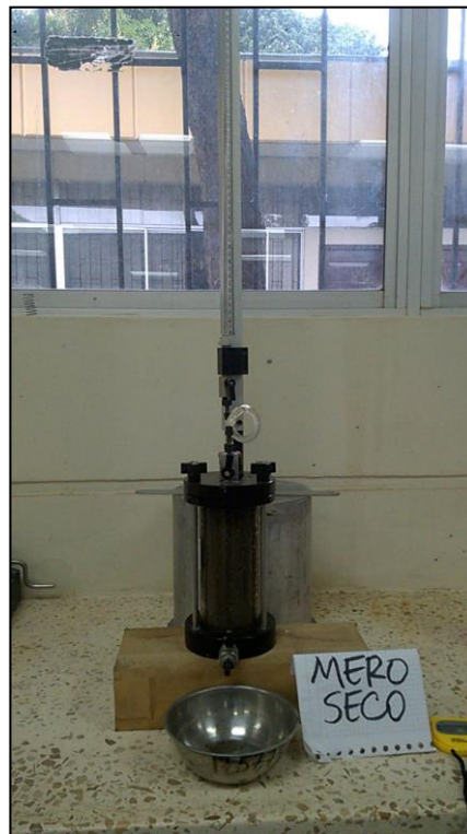
Figura 2. 21 Ensayo de Permeabilidad de la muestra consolidada de la Cuenca # 3.
