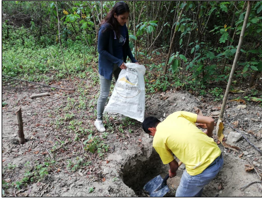
Figura 2. 4 Toma de muestras de la calicata de la cuenca # 3.
