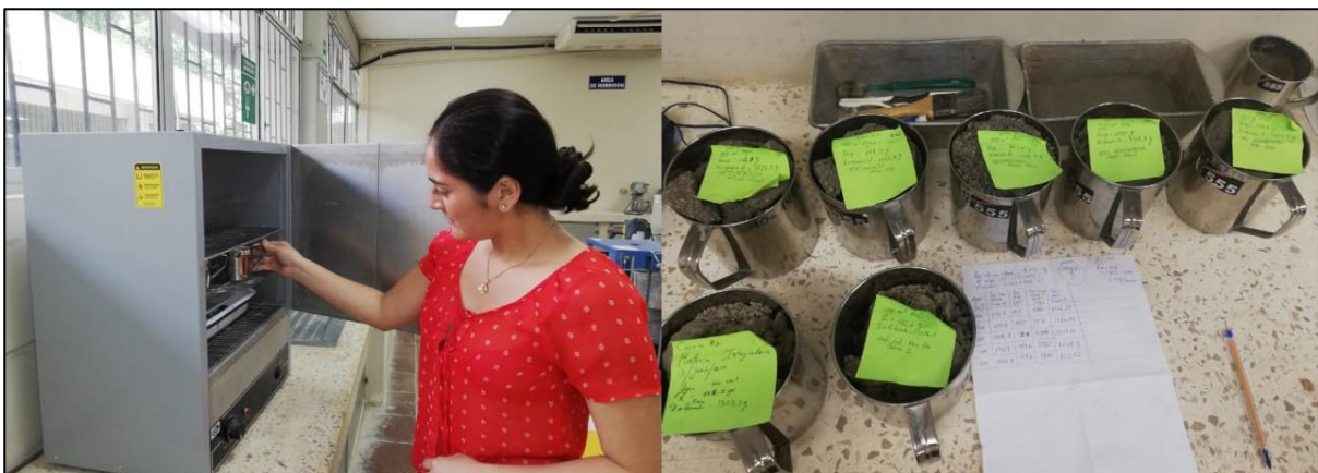
Figura 2. 18 Muestras sacadas del horno para su posterior toma de pesos.
