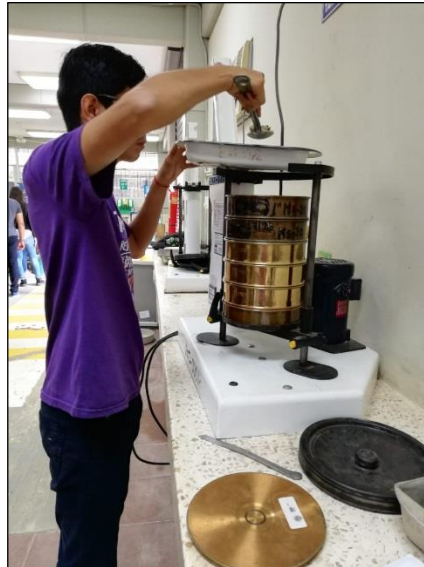
Figura 2. 16 Realización del ensayo de granulometría.
