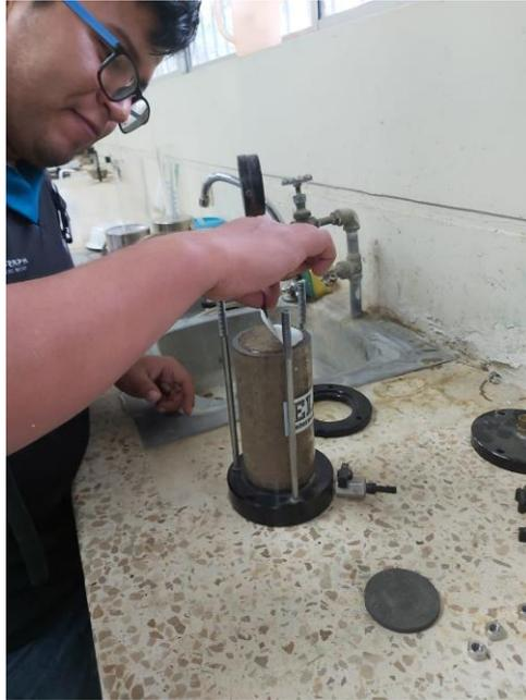
*Figura 3.28 Inicio Ensayo de Permeabilidad en el Laboratorio. Fuente:
