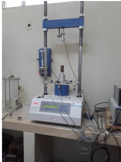
*Figura 3.26 Ensayo de Triaxial No consolidado no Drenado. Fuente:
