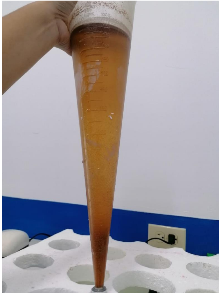
Figura 4. Cono de eclosión de artemia utilizado en la determinación del LC50 de la bacteria patógena.
