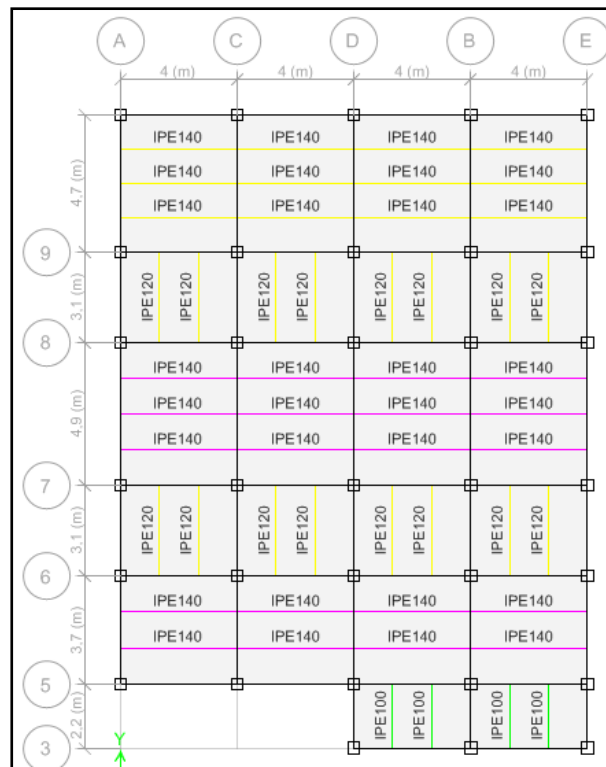
Figura 3.10 Demanda/Capacidad viga secundaria de cubierta bloque 1 [Carreño J., Cañarte J., 2019]
