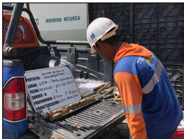
Figura A-125 Extracción de muestra de suelo a 6.55 metros
