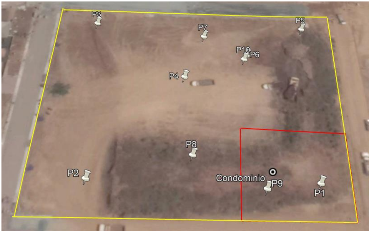
Ilustración 6 Perforaciones del terreno
