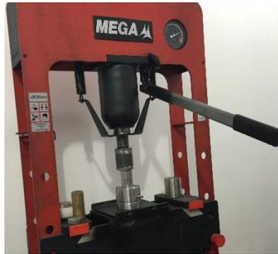
**Figura 2.6. Prensa de 30 t marca MEGA**
