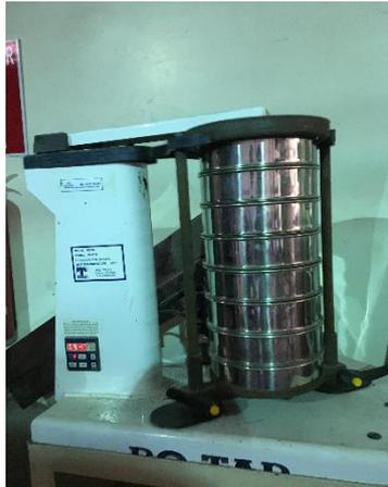
**Figura 2.3. Tamizador de laboratorio Ro-Tap marca Tyler**
