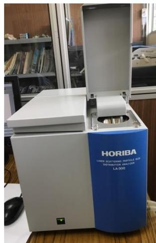
**Figura 2.4. Analizador de distribución de tamaño de partículas por dispersión láser marca HORIBA**
