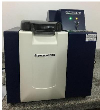
**Figura 2.5. Equipo de análisis de fluorescencia de rayos Supermini200
