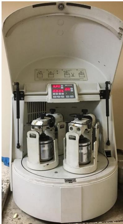
Figura 2.2. Molino planetario
