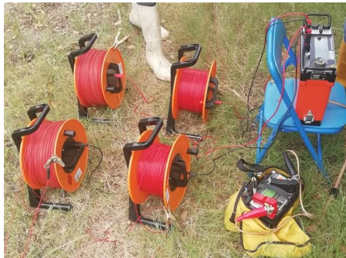
Figura 3.4 Arreglo de los materiales usados en los SEV. Fuente: CIPAT-ESPOL, 2019.
