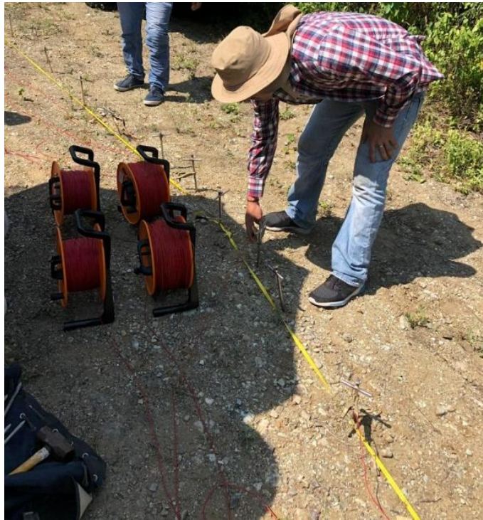
Figura 3.5 Conexión de electrodos con lagartos para la toma de datos. Fuente: CIPAT-ESPOL, 2019.
