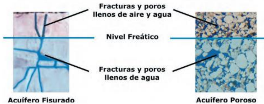
Figura 2.4 Acuífero fisurado y acuífero poroso. Fuente: (Collazo & Montaña, 2012). Manual de agua subterránea. Montevideo.
