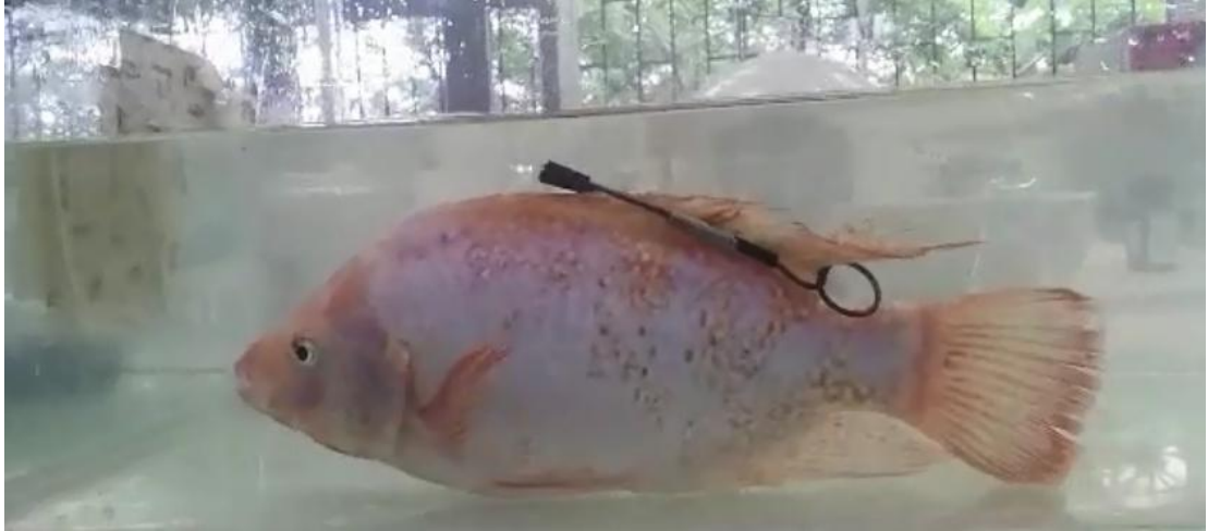
Figura 3.3: Tilapia en pecera como proceso de validación de la abrazadera
