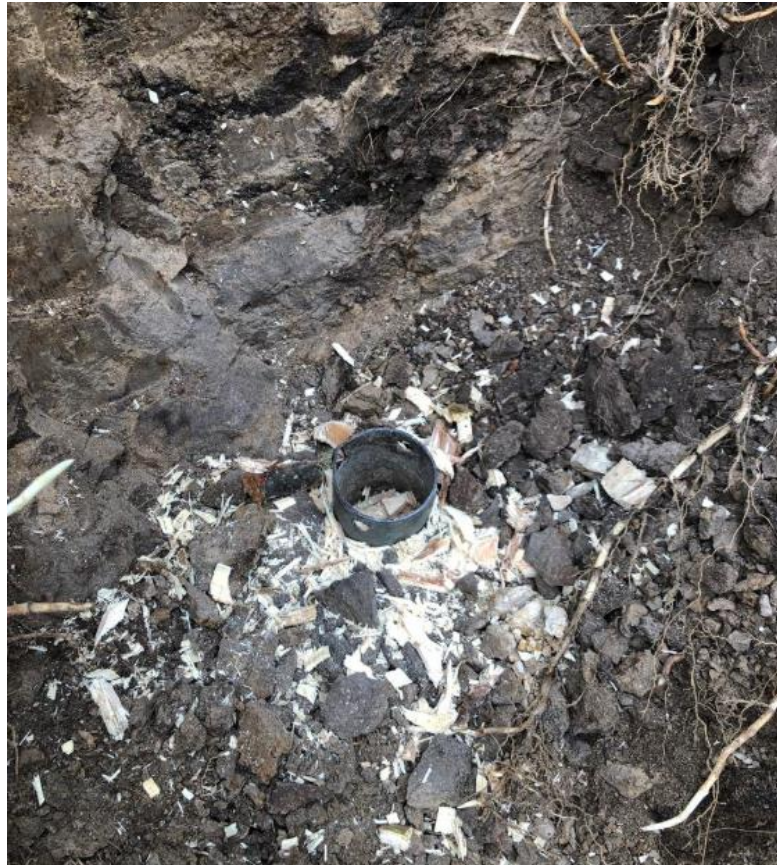
Figura 2.4 Muestreo con tubo shelby.
