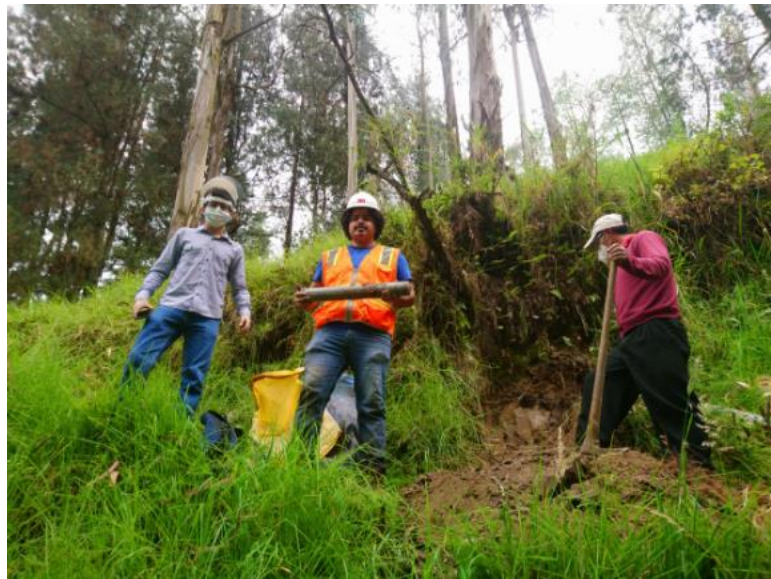
Figura 2.3 Toma de muestra con tubo shelby
