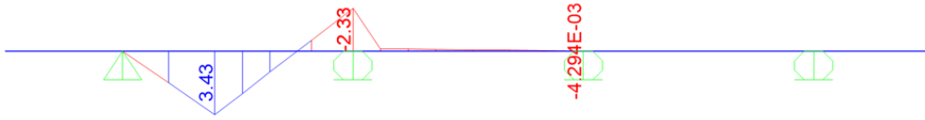
Figura 3.10 Diagrama de momentos por carga viva +M (Ton*m). Fuente: Elaboración propia
