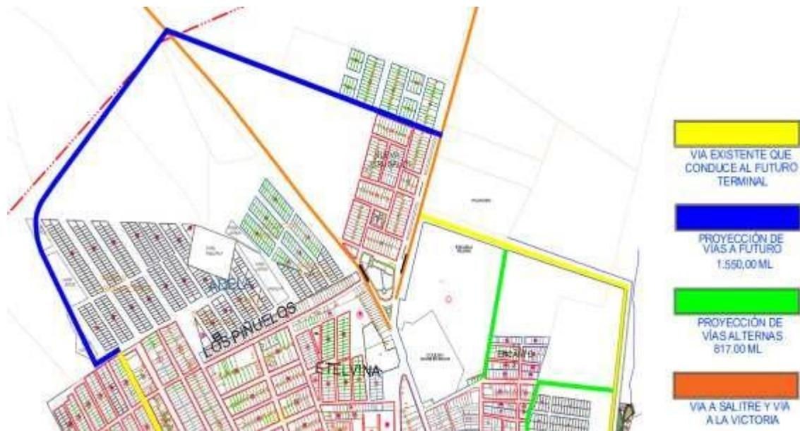
**Figura 2.25. Trazado Preliminar del Proyecto de Vía**
