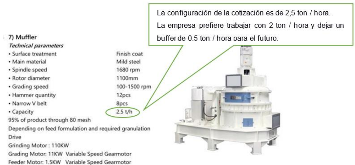
Figura 3.4 Especificaciones técnicas de la máquina de pulverizado
