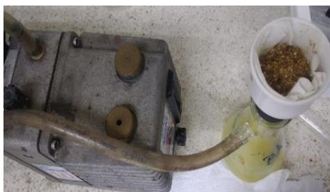
**Apéndice B.3 Filtración al vacío para obtención de la torta de Neem**
