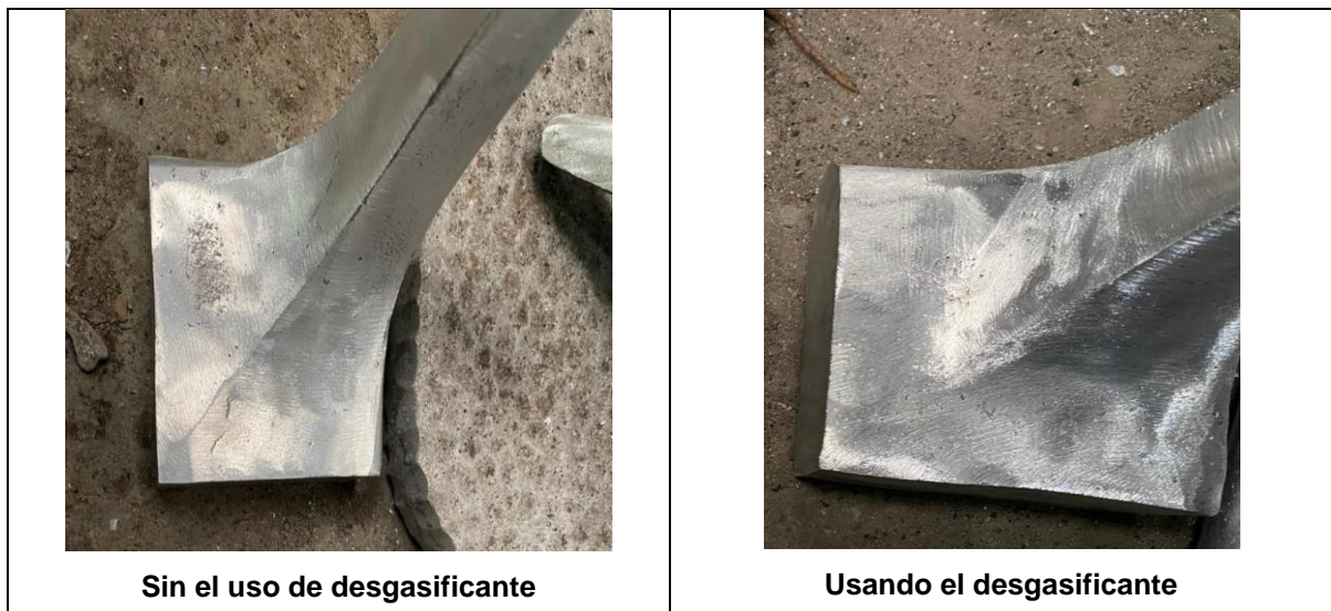
Ilustración 3.5 Resultado del uso de desgasificante en la colada.
