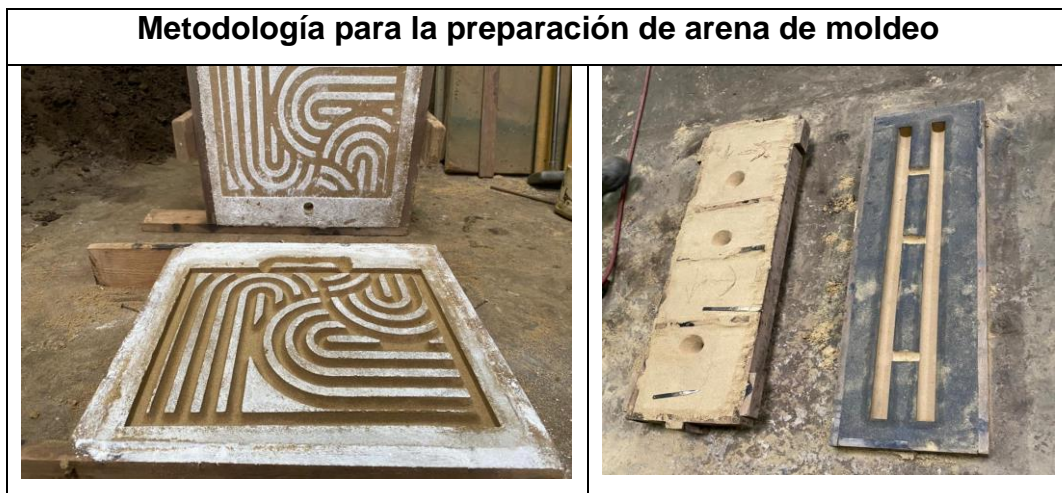
Ilustración 2.5 Moldes de arena
