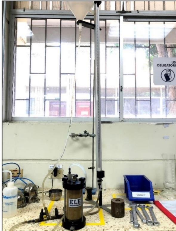
**Figura 3.11** Ensayo de permeabilidad de carga variable.
