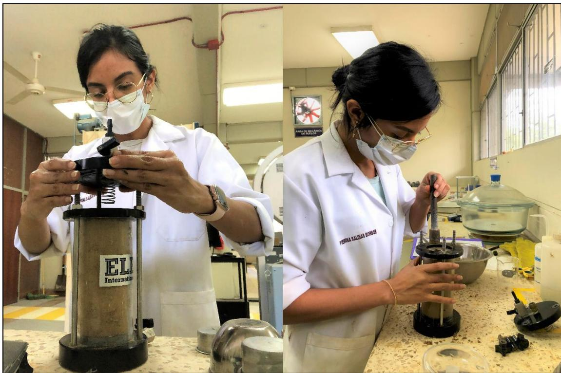
**Figura 3.10** Ensayo de permeabilidad de carga variable. Preparación de cilindro.
