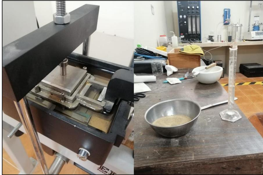
**Figura 3.13 Preparación de muestras y equipo para ensayo de corte directo.**
