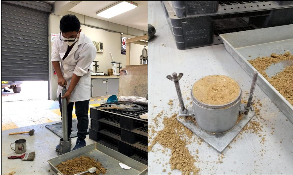
**Figura 3.8 Ensayo de Proctor Modificado. Compactación de capas**
