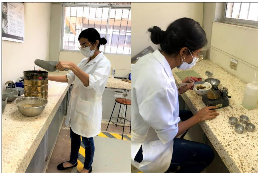
**Figura 3.5 Tamizado y preparación de las muestras para ensayos de Límites de Atterberg.**
