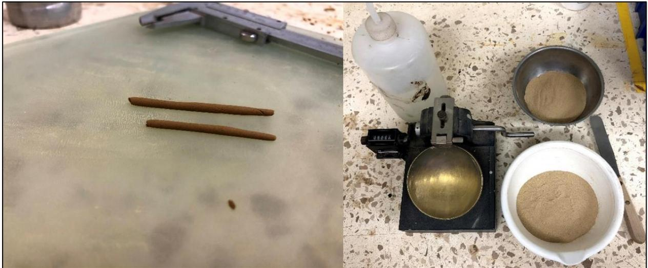
**Figura 3.6 Ensayo de límites de Atterberg.**
