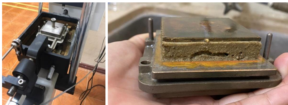
Figura 2.8 Muestra ensayada de Corte Directo Fuente: Novillo R.; Stay, D., 2021
