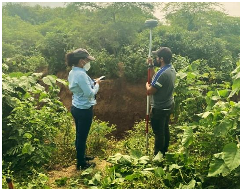
Figura 2.1 Toma de datos topográficos por medio de GPS diferencial. Fuente: Novillo R.; Stay, D. (2021)
