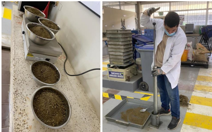
Figura 2.6 Preparación de material y realización de ensayo Proctor modificado. Fuente: Novillo R.; Stay, D., 2021
