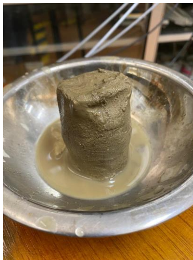
Figura 2.9 Muestra ensayada por Compresión Triaxial Fuente: Novillo R.; Stay, D., 2021
