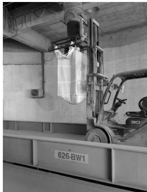
Figura 1.2 Método actual de llenado de big bags con accesorio tipo mini tolva para montacargas Fuente: Empresa de estudio
