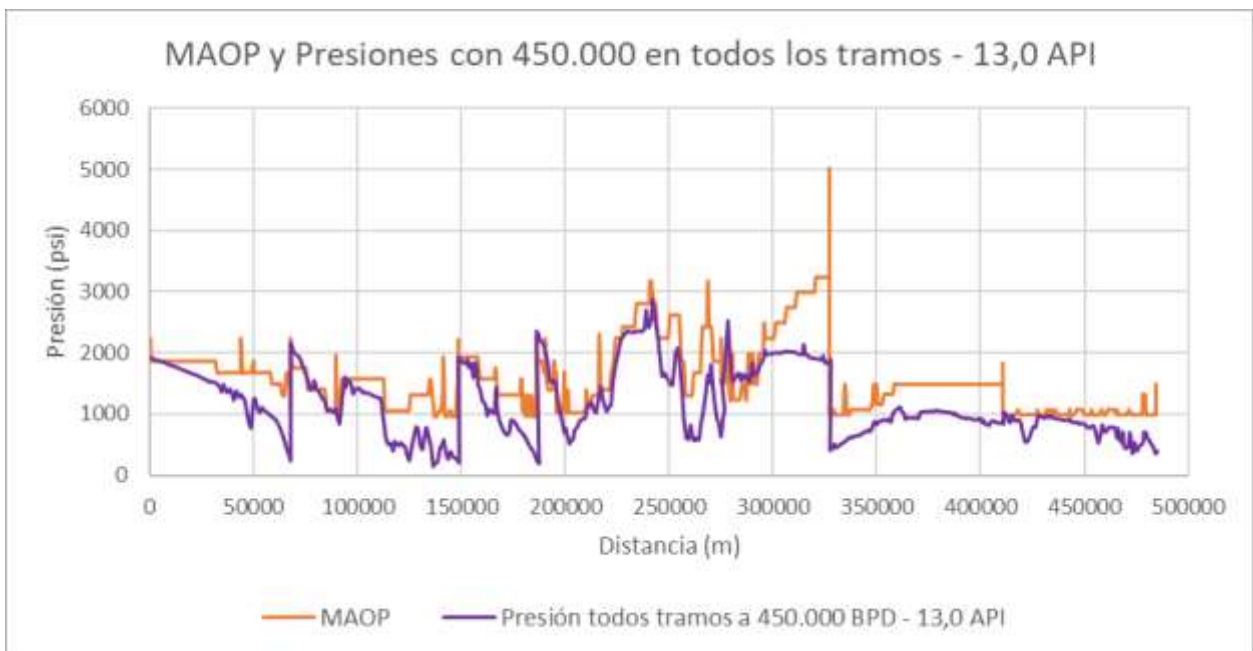
Figura 3.38 OCP: Grafica de MAOP y Presión – 450.000 BPD – 13° API. (Loor&Yagual,2021)
