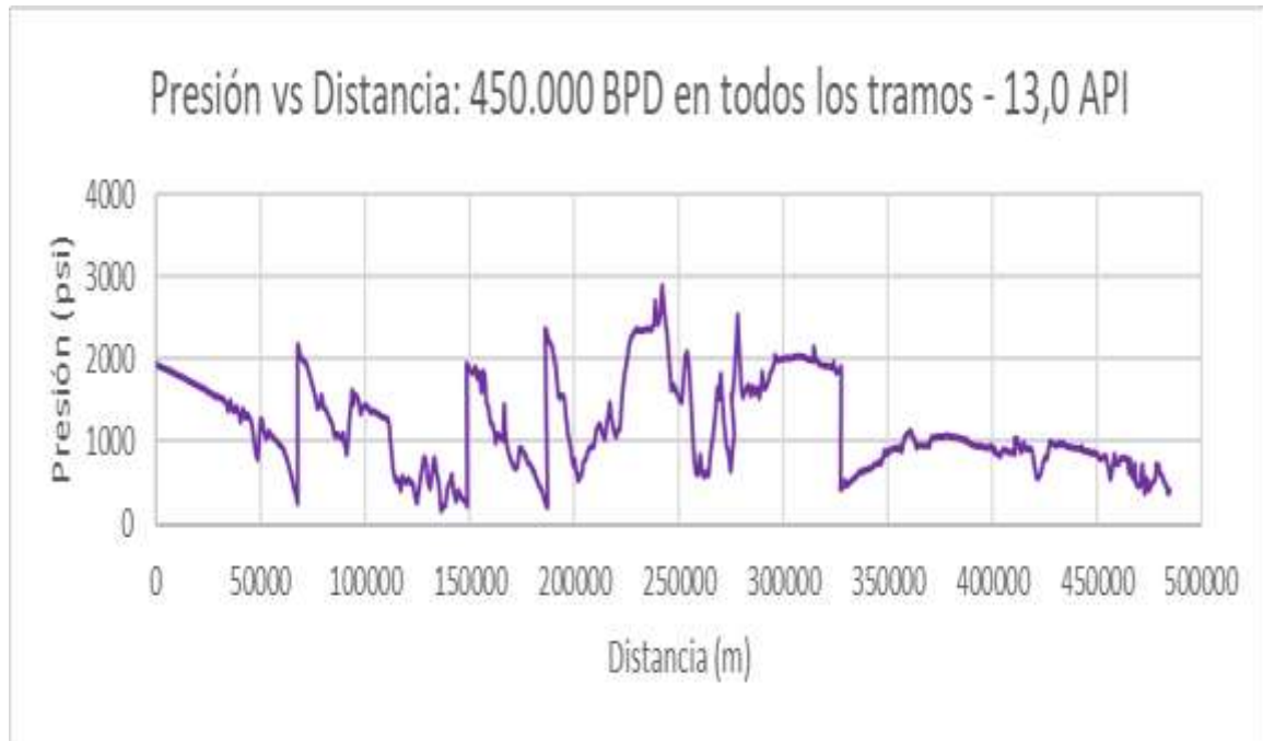
Figura 2.71 OCP: Gráfica de Presión vs Distancia – 450.000 BPD – 13,0 °API. (Loor&Yagual,2021)
