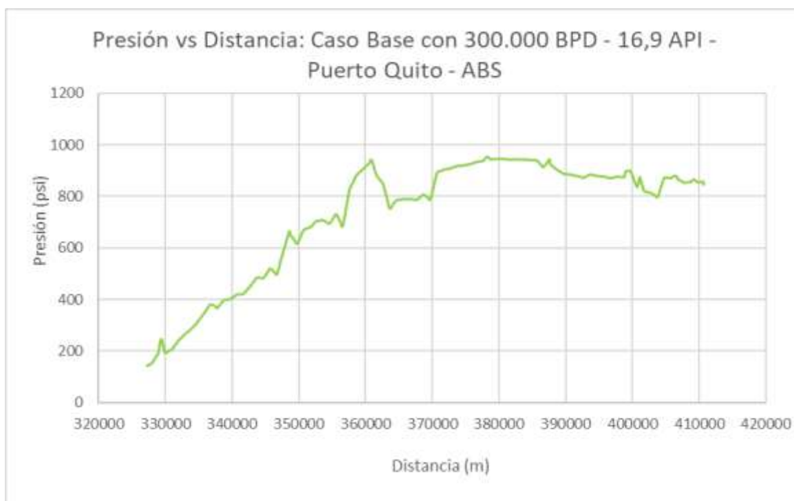
Figura 2.37 OCP: Gráfica de presión caso base – 300.000 BPD – 16,9 °API. Tramo Puerto Quito - ABS. (Loor&Yagual,2021)
