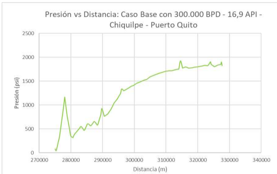
Figura 2.36 OCP: Gráfica de presión caso base – 300.000 BPD – 16,9 °API. Tramo Chiquilpe – Puerto Quito. (Loor&Yagual,2021)
