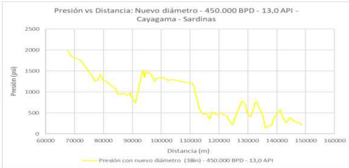
Figura 2.72 OCP: Gráfica de Presión vs Distancia - nuevo diámetro – 450.000 BPD – 13,0 °API. Tramo Cayagama – Sardinias. (Loor&Yagual,2021)
