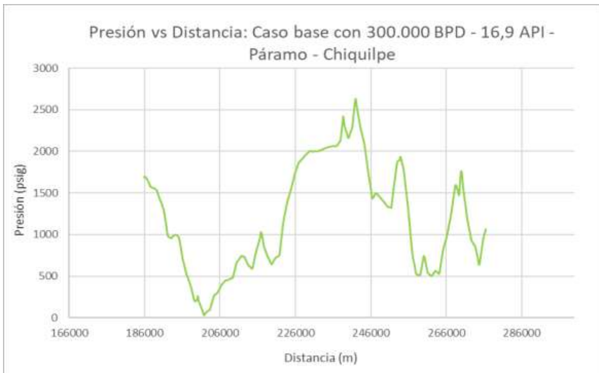
Figura 2.35 OCP: Gráfica de presión caso base – 300.000 BPD – 16,9 °API. Tramo Páramo - Chiquilpe. (Loor&Yagual,2021)
