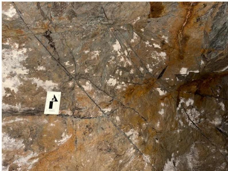
Figura 5.2: Enjambre de vetillas mineralizadas. (Abs. 0+644 – Flanco izquierdo), fuente: autores
