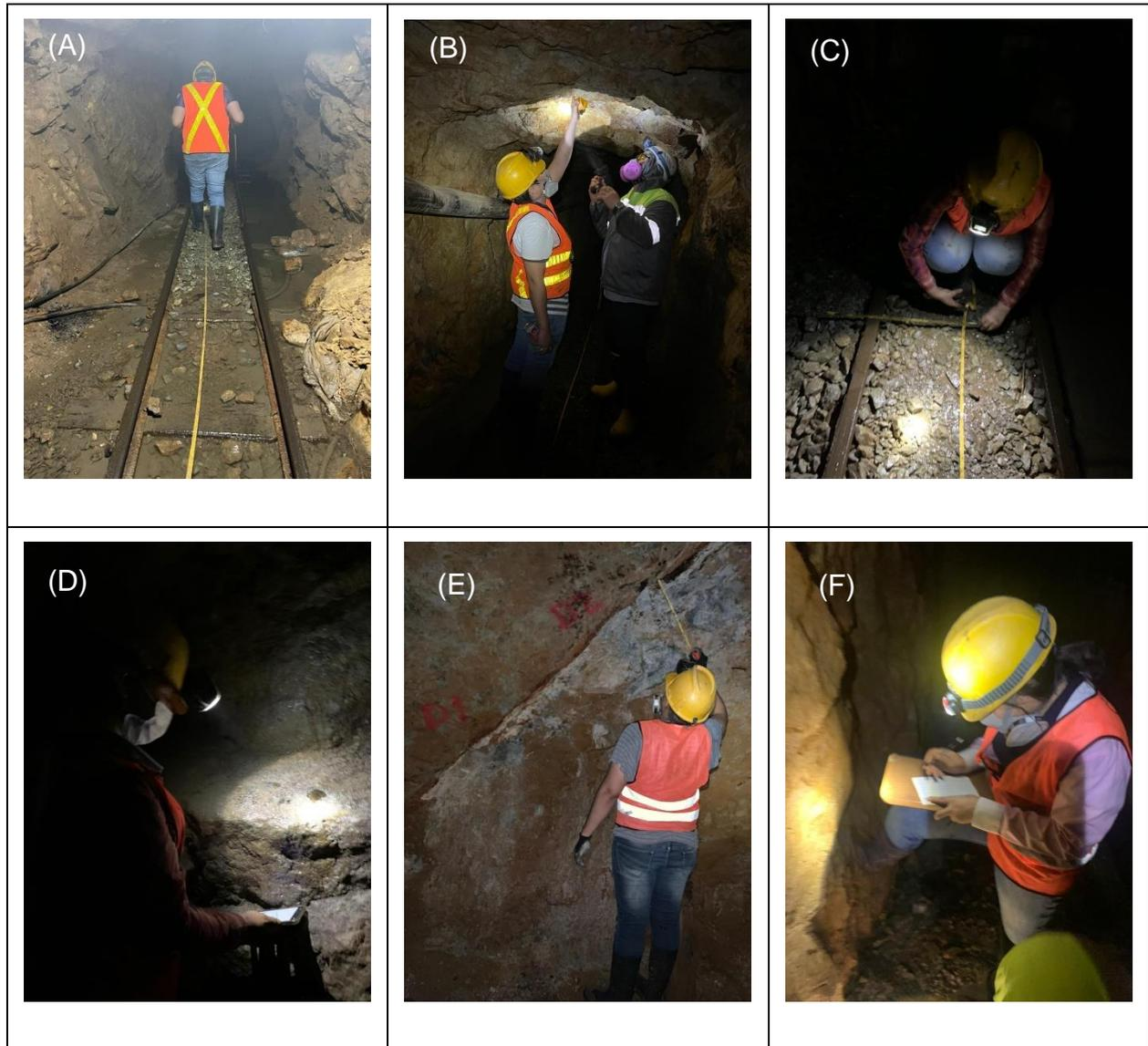
**Figura 4.4: Metodología aplicada para levantamiento de información estructural en la mina R-Nivel. (A) Colocación de la cinta. (B) Identificación de estructuras. (C) Toma de abscisaje. (D) Toma de Dip y DipDir. (E) Toma de espesor veta. (F) Graficación de las estructuras identificadas**
