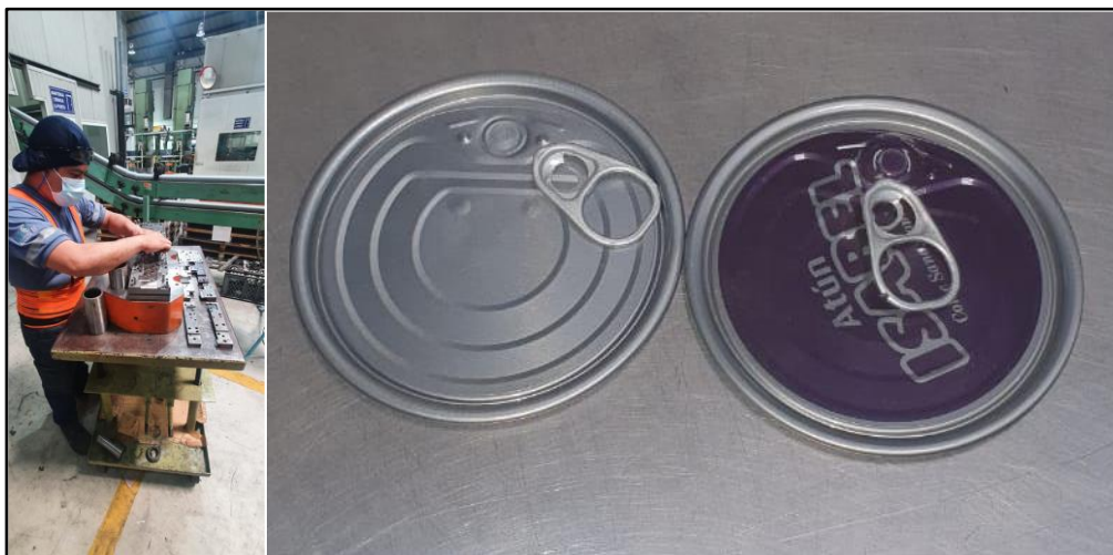
Figura 2.25 Verificación del centrado incorrecto del troquel de vincha
