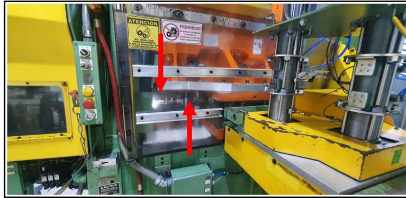
Figura 2.20 Falta de paralelismo en la estación de la incisión
