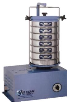
**FIGURA 3.4 MÁQUINA DE ENSAYO DE GRANULOMETRÍA**
