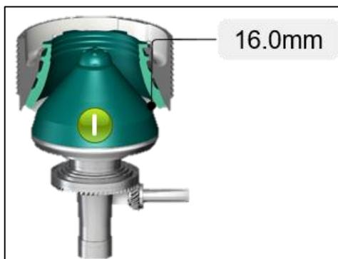
**FIGURA 2.2 MEDIDA DE AJUSTE DE UNA TRITURADORA**
