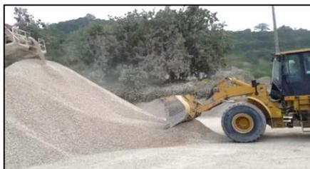
**FIGURA 3.2 HOMOGENIZACIÓN DEL PRODUCTO**
