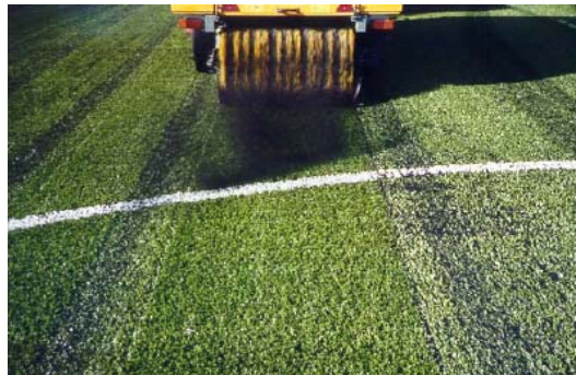
Figura No 2.10 Cepillado y fibrilación
