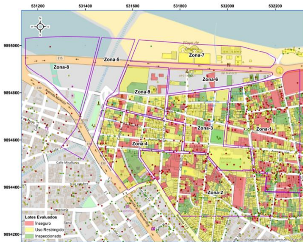
Figura 5. Vulnerabilidad de Estructuras Manta post-sismo 2016
