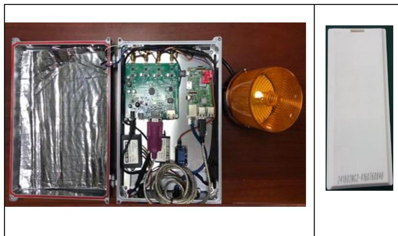
Figura 5.2. Unidad de Lectura y TAG RFID utilizados
