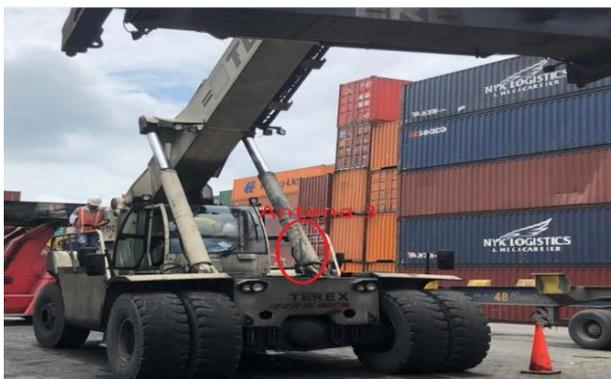
Figura 5.18. Ubicación de antena frontal en la grúa
