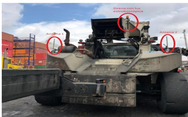
Figura 5.17. Ubicación del Sistema de Prevención de Accidentes en una grúa
