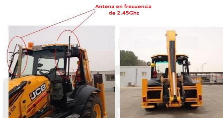
Figura 1.5. Colocación de antenas de 2.45 GHz en una excavadora
