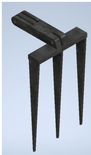
Figura 2.5 Garra encargada de realizar el trinchado de suelos
