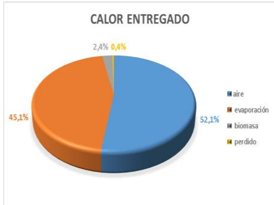
Figura 3.1 Calor neto entregado a los elementos del sistema de secado
