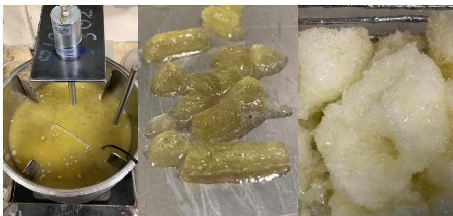
Figura 3.13. De izquierda a derecha: Muestras de aceite saturado, muestra de cristales de cera sin aceite [Elaboración Propia]
