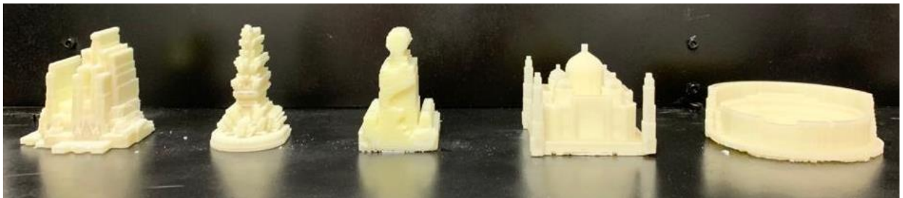
Figura 3.11. Monumentos impresos para prueba de tiempo general de remoción [Elaboración Propia].
