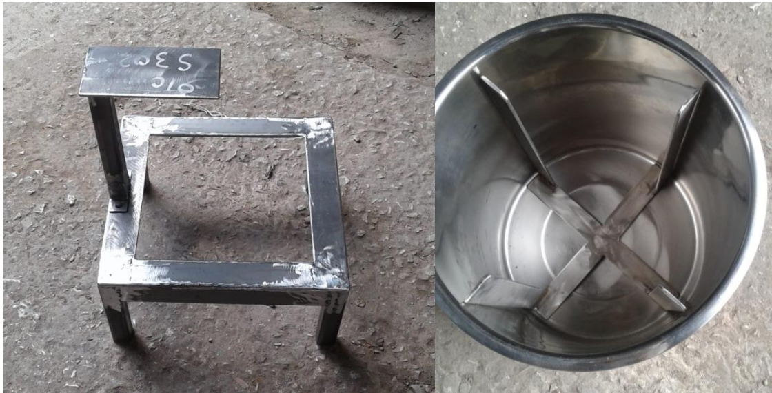
Figura 3.2. Fabricación de estructura y deflectores [Elaboración Propia]
