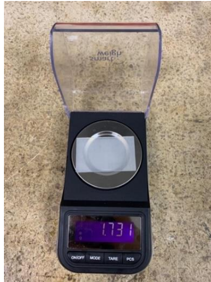
Figura 3.10. Pesaje de impresión de una pletina 200x400x1mm [Elaboración Propia]
