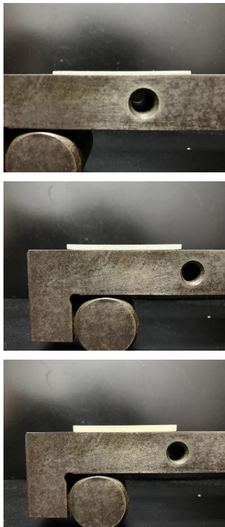
Figura 3.8. Comprobación de deflexión en placas. De arriba a abajo: placa 1mm, placa 2mm, placa 3mm espesor [Elaboración Propia]
