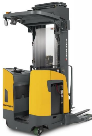
Ilustración 3.35 Montacargas eléctrico para doble profundidad Fuente: Agencia-alemana.com
