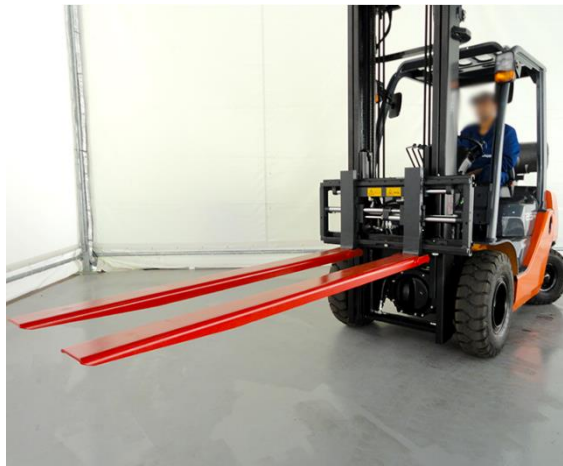
Ilustración 3.36 Montacargas regular con extensiones de horquillas Fuente: saur.com.br
