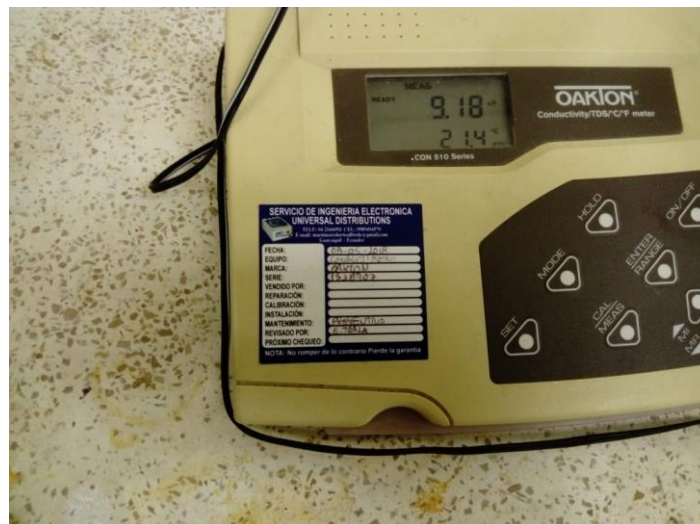
Figura 2.24 Medición de la conductividad eléctrica
