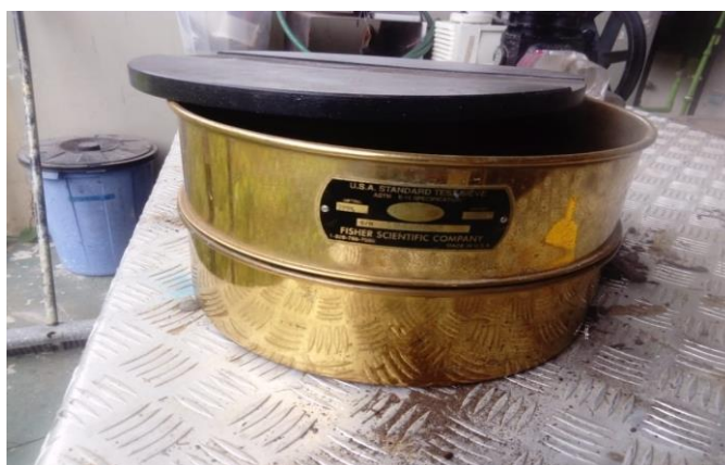
Figura 2.16 Tamizado de la muestra para su tratamiento
