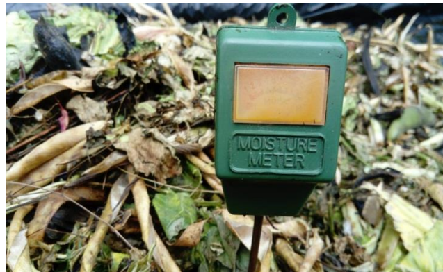
Figura 2.32 Medición de la humedad durante el proceso
