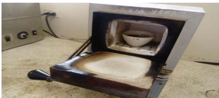
Figura 2.22 Muestra colocada en la mufla a 550 grados Celsius
