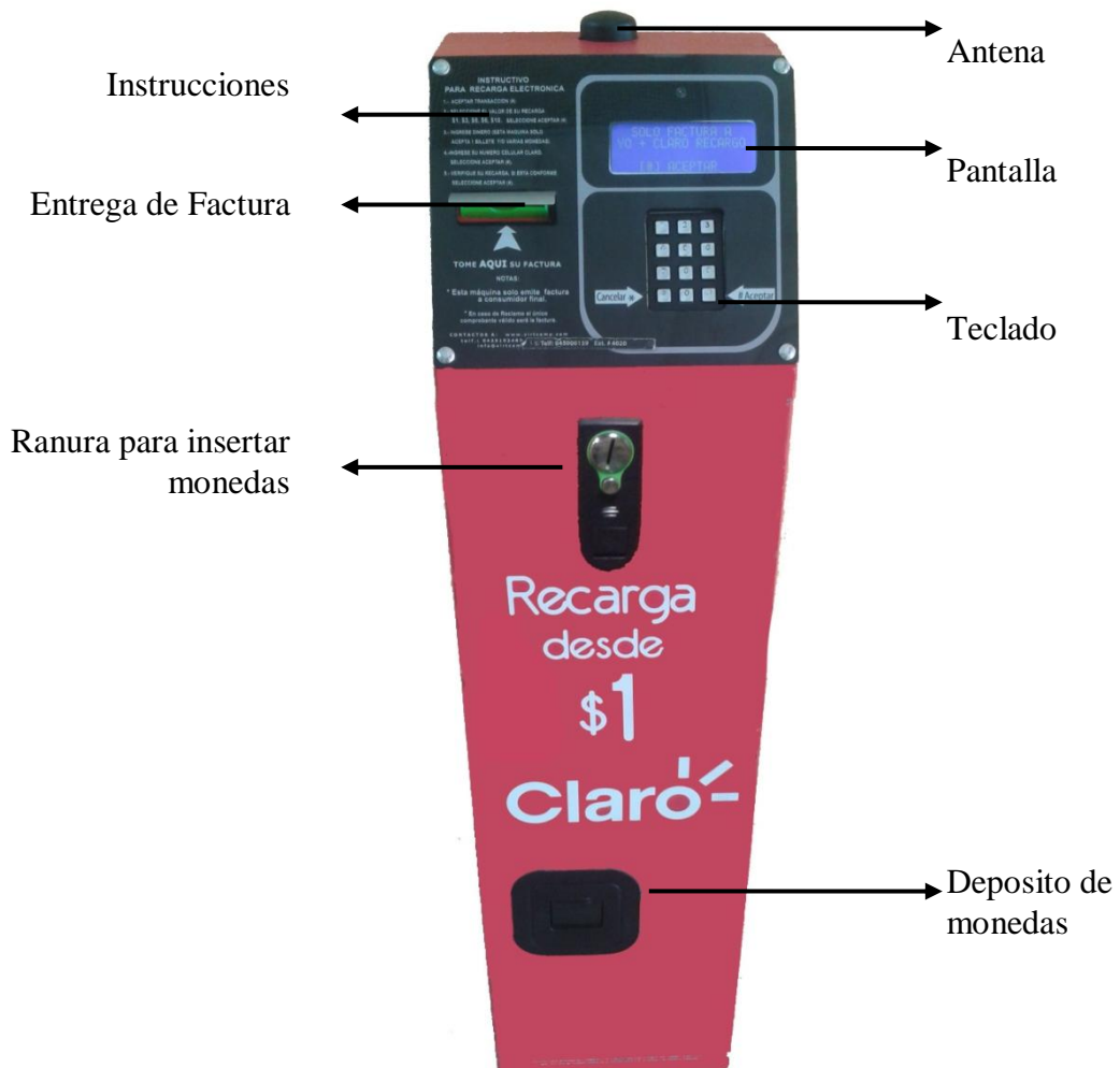
Ilustración 1: Vista frontal de la vending machine
