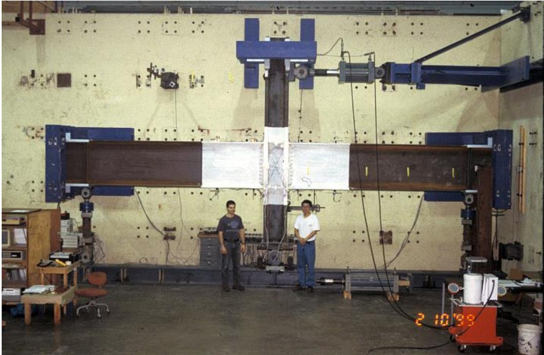
**Figura 5.7.** Fotografía de un espécimen de un ensayo de cruciforme real (Engelhardt, 2007a)
