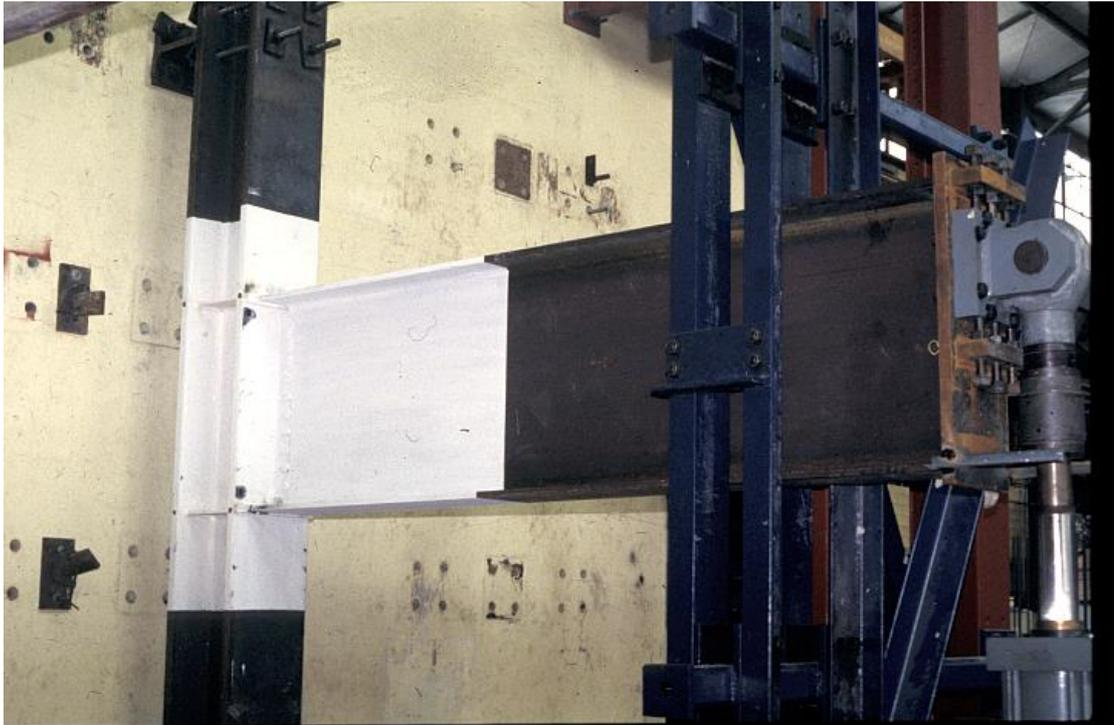
**Figura 5.3.** Fotografía de un espécimen en forma de “T” en un ensayo de conexiones real (Engelhardt, 2007a)
