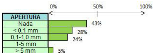
Figura 50 Apertura. Estado de las juntas. Global
