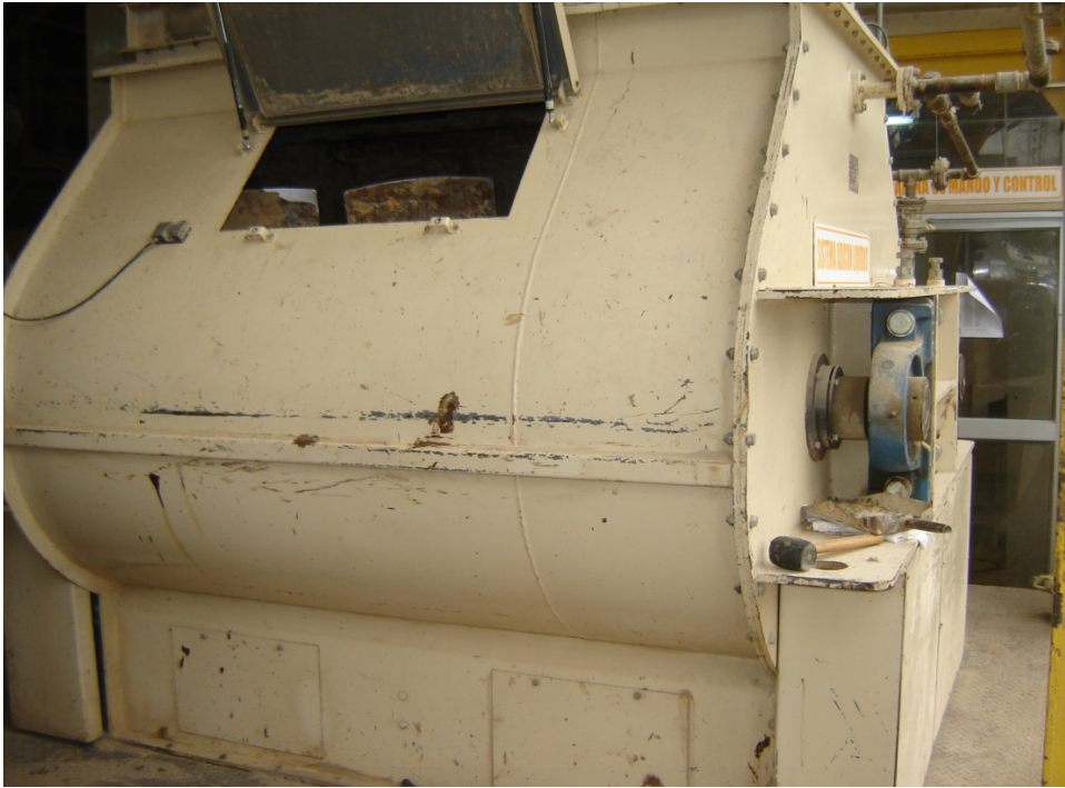
Figura 1-8. Mezcladora de Paletas de doble eje (cortesía Alimentsa)
