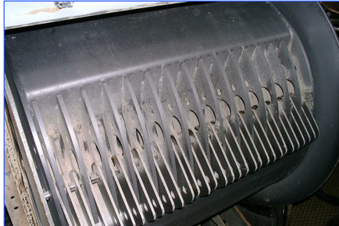
Figura 2-14. Rotor acoplado con los martillos de un Molino (cortesía Sprout Matador)
