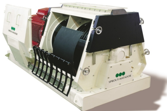
Figura 2-2. Molino de Martillos (cortesía compañía Sprout Matador)
