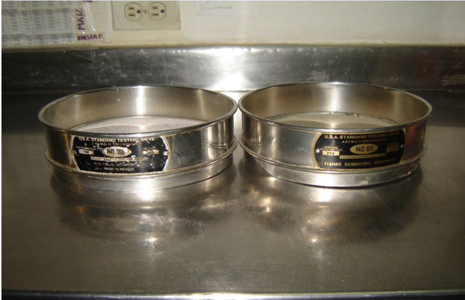
Figura 1-10. Tamices No. 20 y No. 60 para medir tamaño de partículas.
