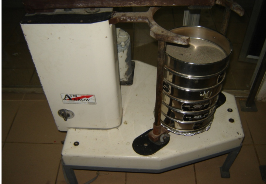
Figura 1-9. Equipo Tamizador utilizado para medir diferentes tamaños de partículas.
