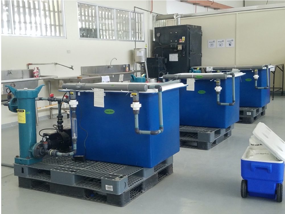
Gráfico 1. Sistema de depuración para moluscos bivalvos, a nivel de laboratorio.
