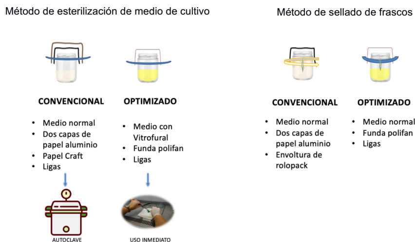
Figura 1.1 Métodos de esterilización de medio de cultivo y sellado de frascos en biofábrica.
