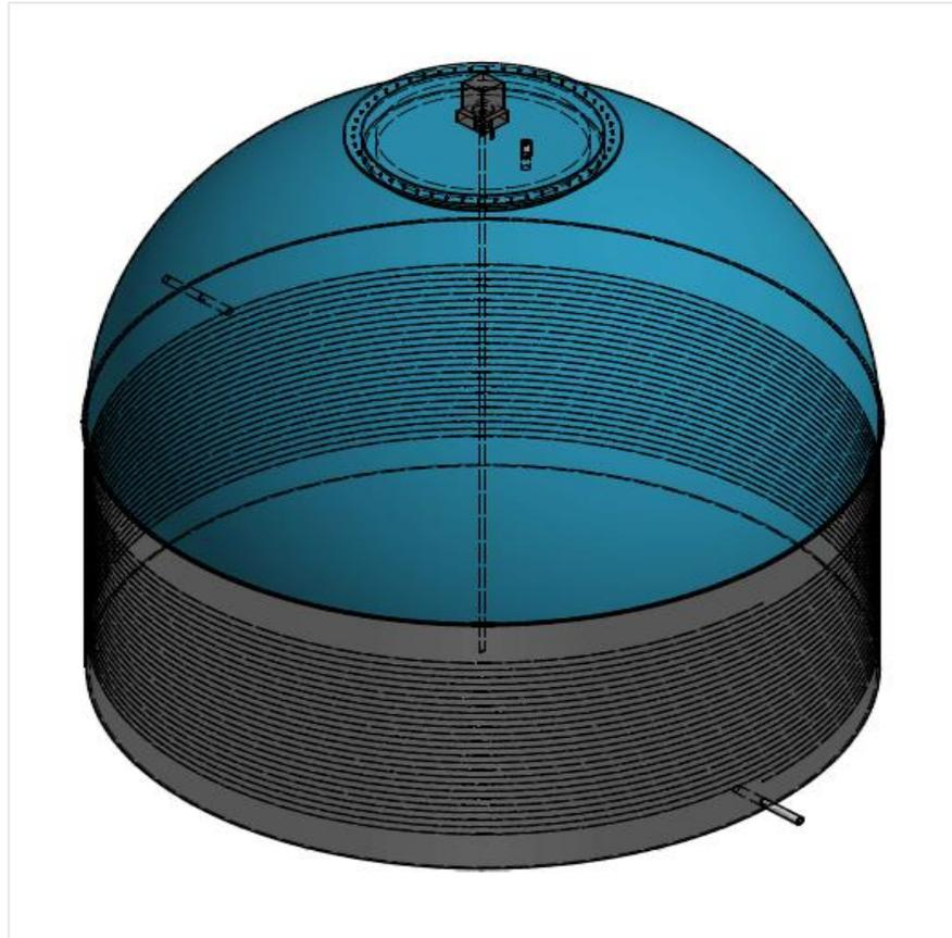
**Figura 3.8 Vista isométrica del diseño del biodigestor con sus correspondientes sistemas de operación**
