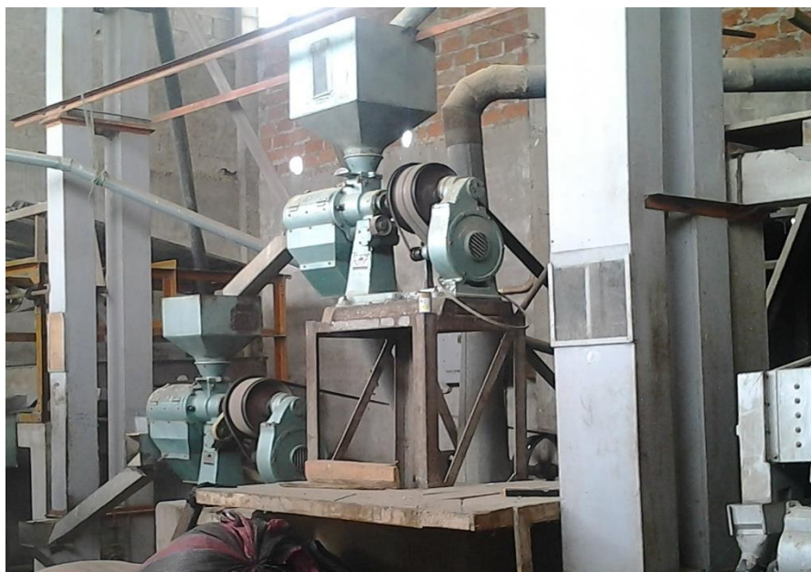
Gráfico 13 - Proceso de blanqueamiento y pulido
